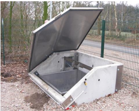
Abbildung 29: Erdkühlung mit externem Kühlaggregat; Deckel mit Seilwinde zum Öffnen; Abholung ohne Befahren des Betriebes ©LMG Nord
