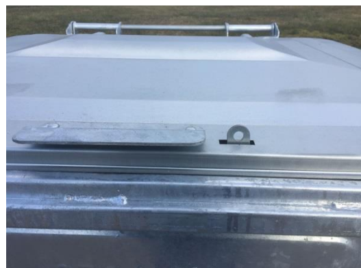
Abbildung 13: Container mit Möglichkeit zum Abschließen ©SecAnim
